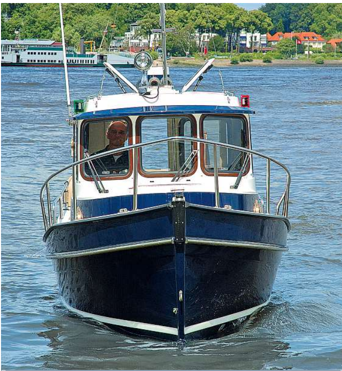
In wenigen Sekunden wird der stählerne Signalmast gelegt, so dass sich die Durchfahrthöhe der R-21EC auf 2,03 m verringert
