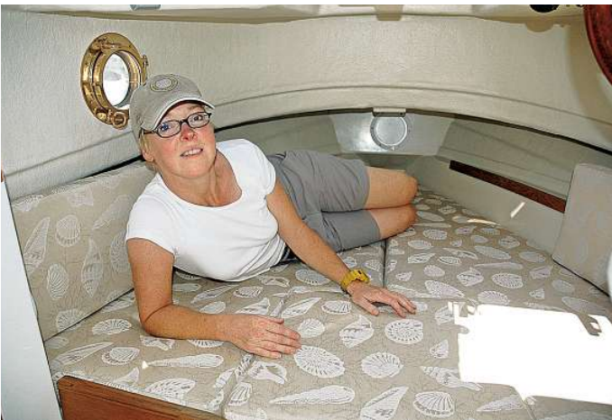
Im vorderen Bereich des Deckshauses wurde eine bequem gepolsterte V-Doppelkoje mit den Maßen 195 x 150 cm angeordnet
