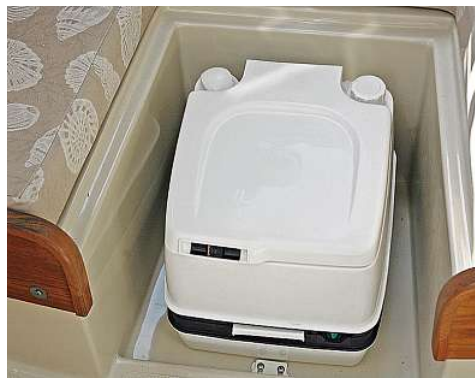
Unter dem Kojenpolster kommt eine Chemie-Toilette zum Vorschein. Gegen Aufpreis ist ein Marine-Pump-WC mit Septiktank erhältlich
