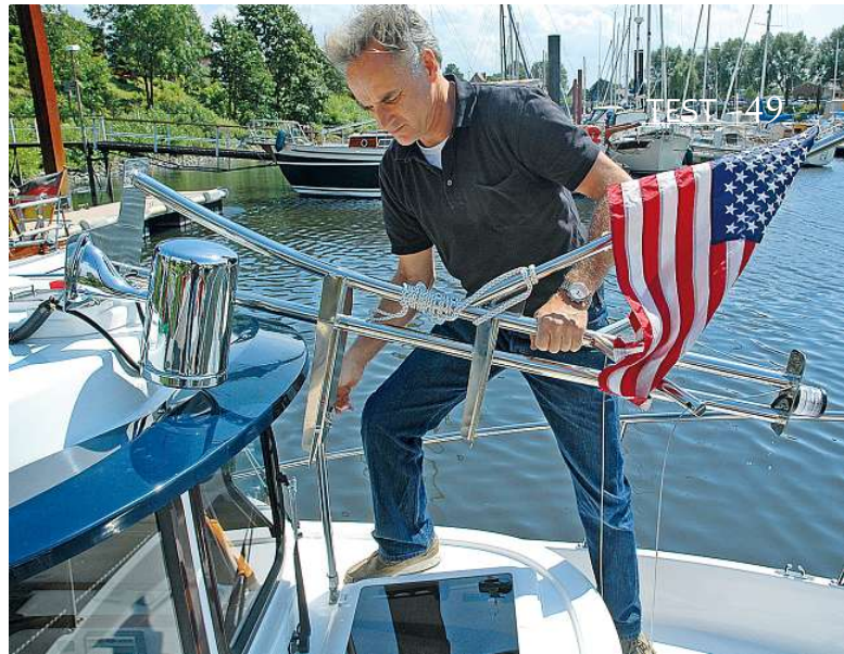
In wenigen Sekunden wird der stählerne Signalmast gelegt, so dass sich die Durchfahrthöhe der R-21EC auf 2,03 m verringert
